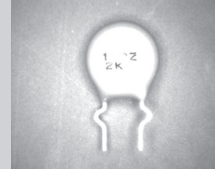
CRH-3667-RGB (開紅光)調高 光源亮度後進行電容文字辨識
