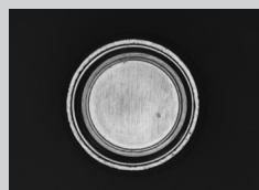
CHL-4040-W, 金屬鍍膜凸點瑕疵檢查
