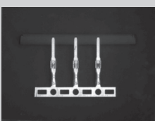
CHL-5050-R， 端子表面損傷檢查及量測
