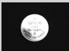
CHL-4040-W， 電池表面凹陷檢查
