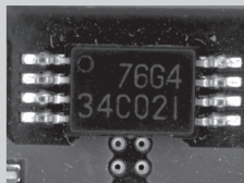
QDL-3030-W， IC 焊接檢查
