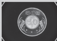
CRF-6090-W，突顯硬幣 表面凹凸及細微刻痕
