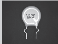
CRH-3667-RGB (開藍光) ，電容零件文字辨識
