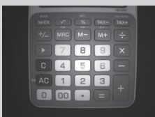
CRH-70120-W，計算機 鍵盤照明不平均
