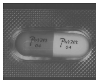
環形光加上偏光板後 有效降低反光
