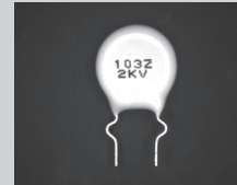
CRH-3667-RGB (開藍光)調高 光源亮度後進行電容文字辨識
